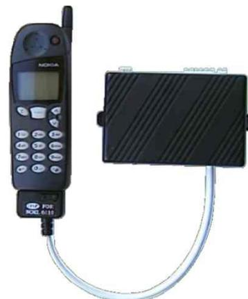
Устройство GsmAlarm-012 действует совместно с аппаратами сотовой связи NOKIA 5-ой или 6-ой серии и может быть приспособлено для охраны помещений и автомобилей, дистанционном управлении четырех независимых устройств или для передачи параметров SMS сообщениями.
